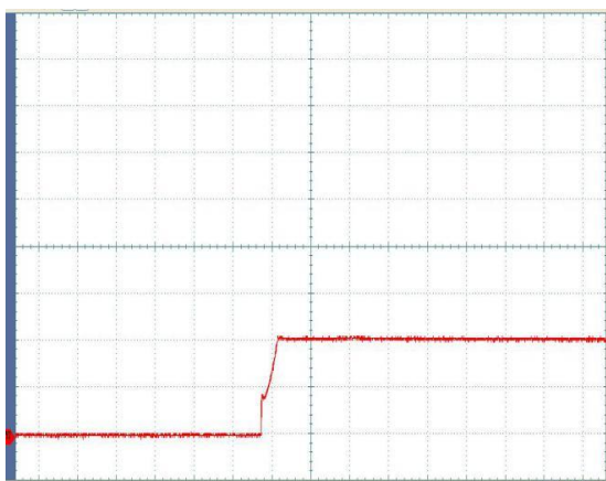
通过电源和开关启动软启动。当电流为 2A 时，电压为 2V。
